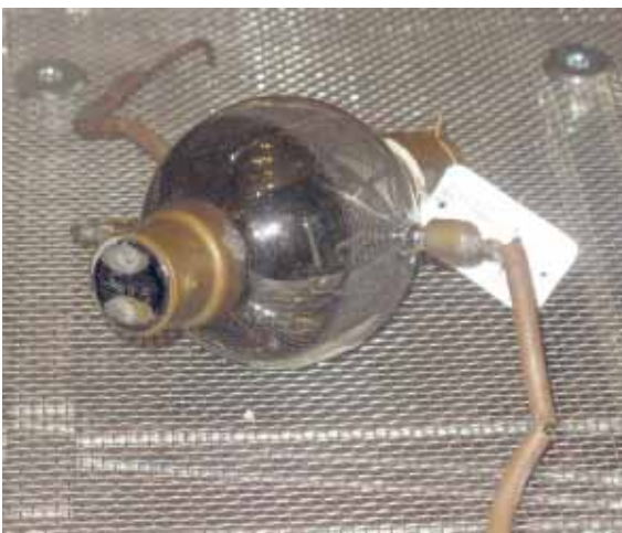
Рис.9. Трехэлектродная радиолампа конструкции М.А. Бонч-Бруевича. 1915 г. Экспонат Музея связи России им. А. С. Попова. Санкт-Петербург.
