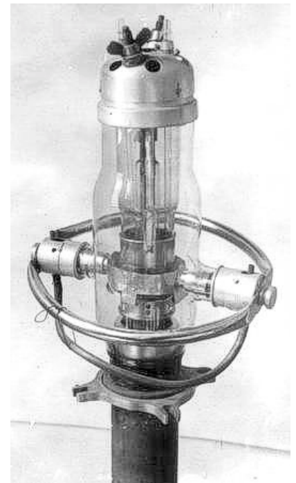
Рис.6. Газовая лампа Папалекси. Изготовитель завод РОБТиТ. 1916 г.
