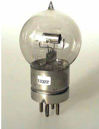
Рис.12. Радиолампа SFR SBR тип RP французской фирмы SFR. 1916 г.
