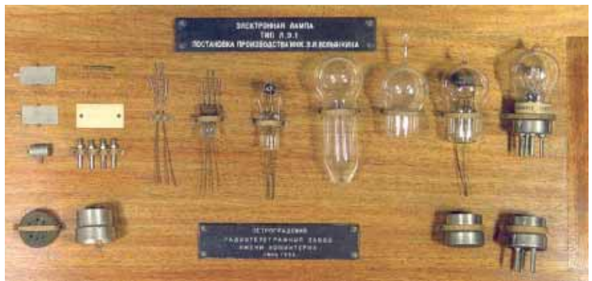
Рис.15. Конструкция радиолампы Волюнкина. 1915 г. Экспонат Музея связи России им. А. С. Попова. Санкт-Петербург.
