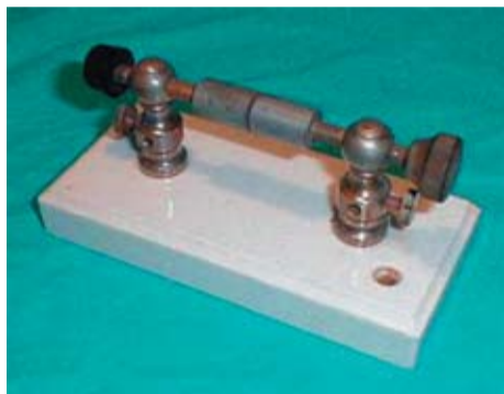
Конструкция воздушного разрядника
