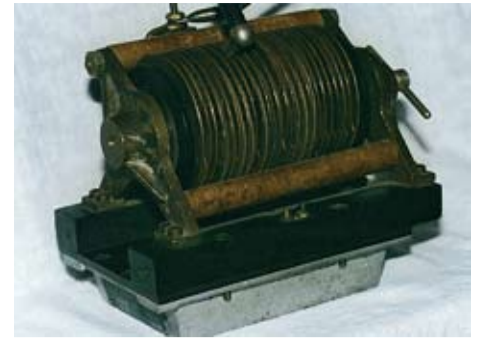
Многочастотный искровой разрядник конструкции Макса Вина
