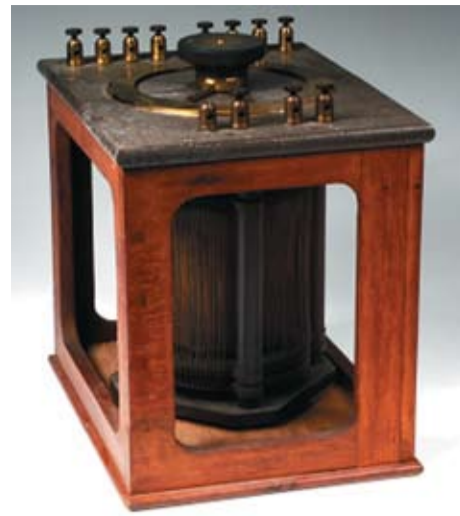
Пеленгатор Marconi Bellini-Tosi для обнаружения беспроводных станций. 1916 год
